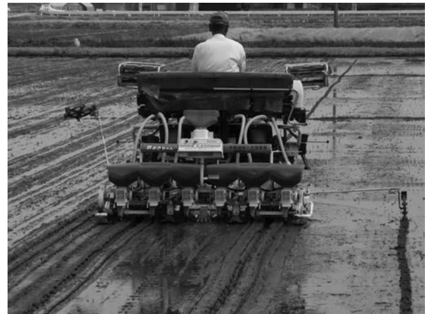
図9. 鉄被覆種子用直播機による土中播種
